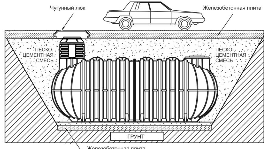
При размещении подземной емкости под проезжей частью, с возможностью доступа к ее содержимому, рекомендуется использовать переходную муфту КН 780. Муфта КН 780 позволяет установить на проезжей части люк смотрового колодца согласно ГОСТ 3634.
