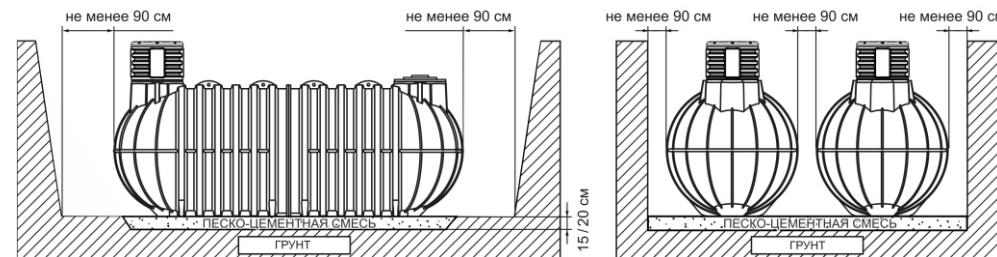
На дне котлована необходимо установить монолитную плиту-основание. Габаритные размеры плиты должны минимум на 500 мм превышать размеры емкости. Толщина плиты рассчитывается проектной организацией на стадии подготовки проекта исходя из объема емкости, уровня грунтовых вод и удельного веса бетона (1 м<sup>3</sup> - 2500 кг).
