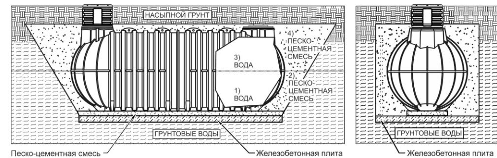
В зависимости от результатов специалист определяет уровень давления грунтовых вод и рассчитывает боковую засыпку и плиту, в частности, боковая засыпка будет иметь необходимую несущую способность, чтобы противостоять сильному боковому давлению. Данная устойчивость может быть дополнительно увеличена введением электросварных сеток.
