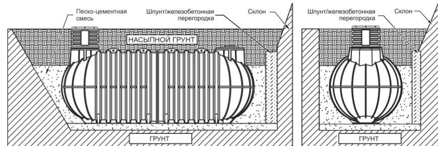
В случае установки емкости в местах движения автотранспорта, дополнительно подготавливается разгрузочная плита для равномерного распределения нагрузки от транспорта. Рекомендуемая толщина составляет не менее 200 мм, а габаритные размеры — на 500 мм больше внешних габаритов емкости по каждому из измерений.
