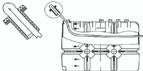
3. Закрепить отвод с помощью гайки.
