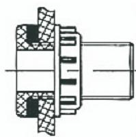
4. Отвод, установленный на бак.
